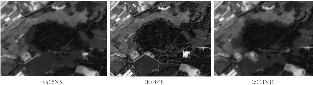
图 4 不同窗口规格影像纹理图 Fig.4 Image texture maps with various windows
